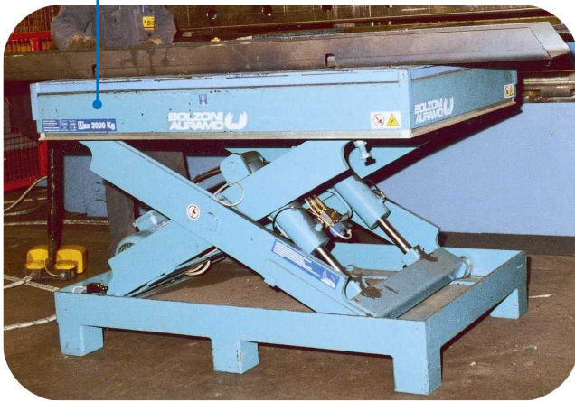
Hubtisch mit Einfachscheren für ungleichmäßig verteilte Lasten
