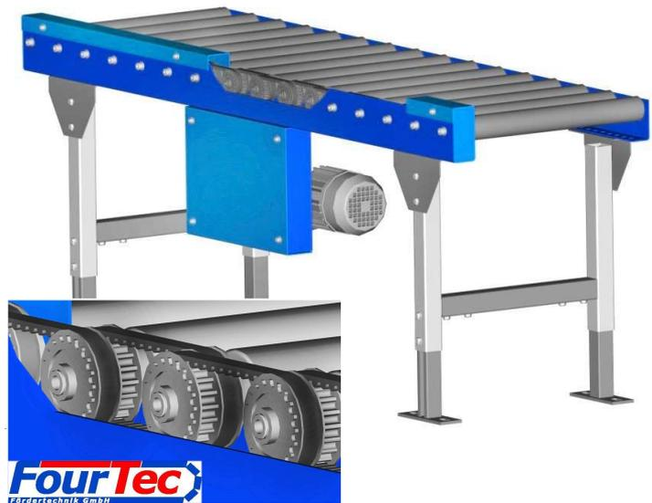
Die angetriebenen Rollenbahnen sind geeignet für den horizontalen oder leicht steigenden Transport von Kartons, Kunststoffbehältern, Fässern, Holzplatten usw. Fördergutgewicht und Größe bestimmen die Rollenteilung und Rollenlänge. In Laufrichtung muss das Fördergut mindestens auf 3 Rollen aufliegen.
