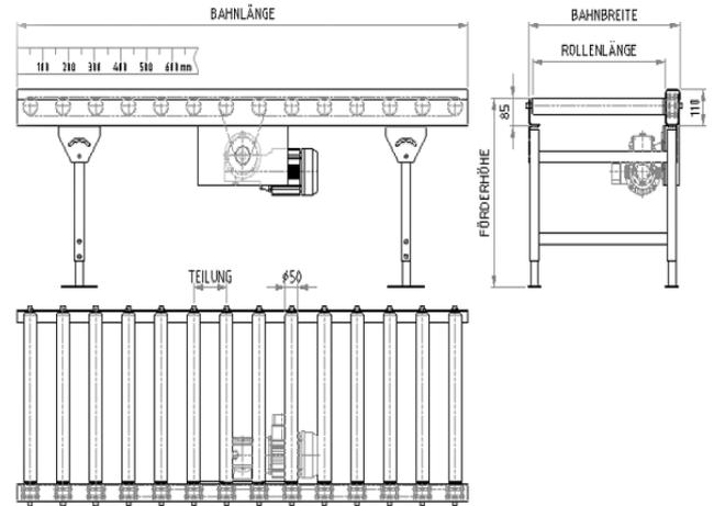
Die angetriebenen Rollenbahnen sind geeignet für den horizontalen oder leicht steigenden Transport von Kartons, Kunststoffbehältern, Fässern, Holzplatten usw. Fördergutgewicht und Größe bestimmen die Rollenteilung und Rollenlänge. In Lauffrichtung muss das Fördergut mindestens auf 3 Rollen aufliegen.
