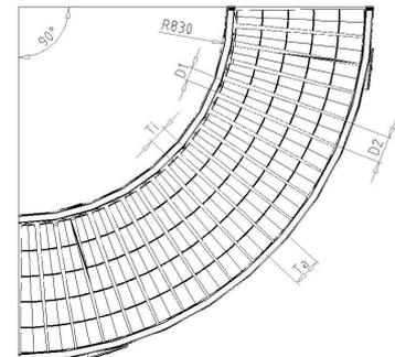
Die Konustragrollenkurven sind geeignet für den horizontalen Transport durch händisches Weiterschleiben, oder mit ca. 5 % Gefälle durch Schwerkraft. In Laufrichtung soll das Fördergut mindestens auf 3 Rollen aufliegen. Der Rahmen besteht aus einem eingerolltem C Profil 100/30/11/2 mm Stahl verzinkt und wird mit Stahlquerdistanzen verschraubt. Die Tragrollen sind aus Stahlrohr  $\varnothing$  50 mm x 1,5 mm Wandstärke und die Kunststoffkonuselemente werden aufgeschoben.
