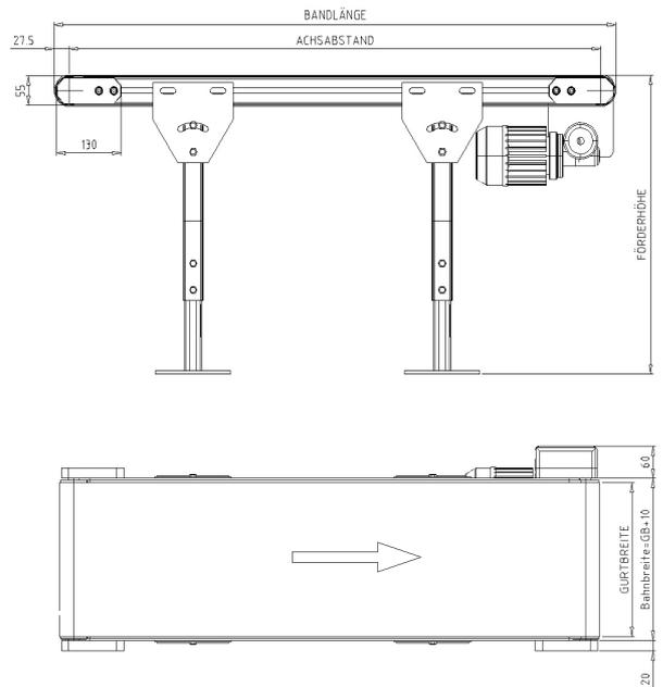
Das Förderband AFB 50 ist ausgelegt für Stückguttransport waagrecht oder steigend. Der Förderbandrahmen besteht aus einem eloxierten Aluminiumsystemprofil 50 x 50 mm in verschraubter Ausführung. Die Trommeln Ø 55 mm sind mit Pendelkugellagern ausgestattet und die Gurtabtragung erfolgt auf einem Niroblech. Der Fördergurt ist in der Standardausführung PVC glatt. Für Steigtransport bzw. Sondereinsatzfälle erfolgt eine Auslegung nach Absprache.
