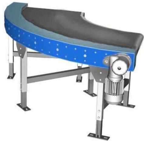
Förderbandkurven werden für den kontinuierlichen Warenfluss bei Eckumlenkungen benötigt. Durch die kleinen Umlenkrollen  $\varnothing 80$  mm,  $\varnothing 47$  mm oder  $\varnothing 22$  mm am Bandanfang und Bandende können auch Kleinteile problemlos gefördert werden.
