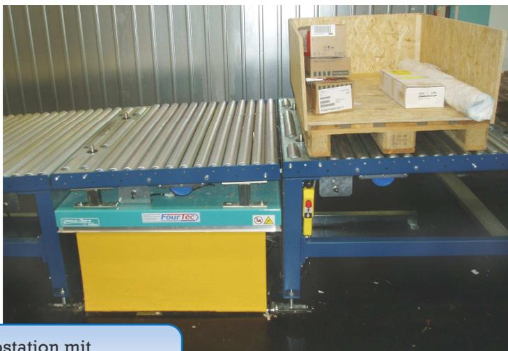
Integrierte Hubstation mit Scherenhubtisch
