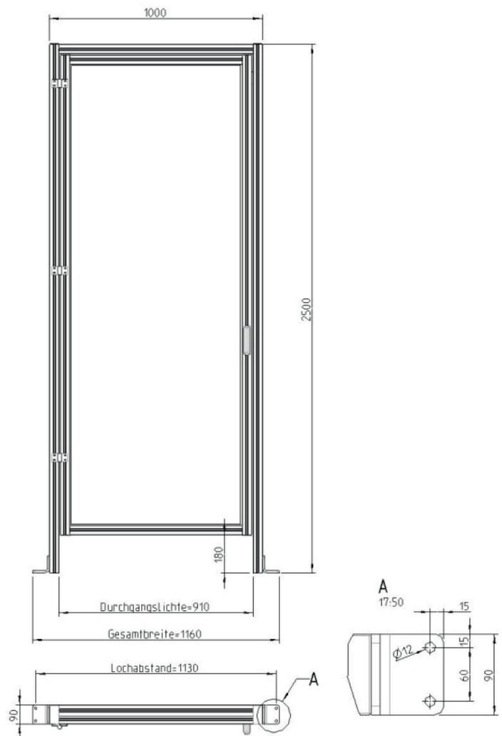
Montageplatten für Sicherheitsschalter, Zuhaltungen, Anbauteile, etc. werden von uns nach Kundenwunsch gefertigt und bei Bedarf auf den Elementen vormontiert. Sonderbreiten auf Anfrage lieferbar.
