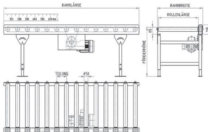
Die angetriebenen Rollenbahnen sind geeignet für den horizontalen oder leicht steigenden Transport von Kartons, Kunststoffbehältern, usw.
