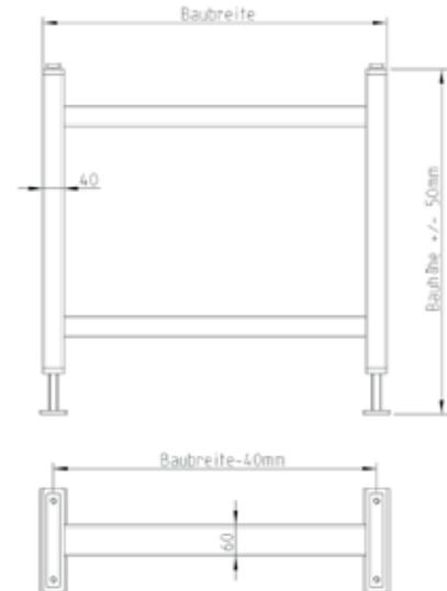
Die Verstellunterstützung UST 60 ist eine Schweißkonstruktion bestehend aus Formrohren 60x40x3 mm.
