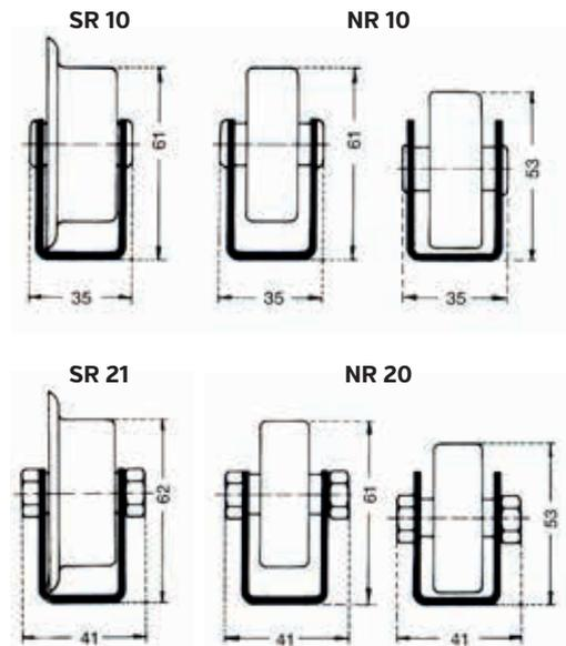
Universalrollenschienen bestehen aus einem kaltprofilierten, sendzimirverzinkten Stahlprofil von 2 mm Stärke. Das Profil hat 2 verschieden hohe seitliche Lochreihen mit einem Teilungsraster von 25 mm und eine Lochreihe im Boden, ebenfalls im Raster von 25 mm.
