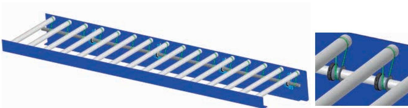
Rundriemen sind kosteneffektiv und leicht montierbar, relativ geringe Leistungsübertragung, Tragrollen mit geformter Sicke (ein oder zwei) im Stahlrohr oder mit zusätzlichem Kunststoff-Rundriemen-Antriebskopf.
