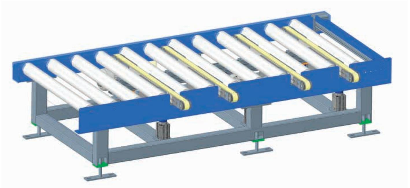
Eckumsetzer werden vorrangig für das Umsetzen von Paletten, Gitterboxen, Boxen und Langgut herangezogen. Weitere Anwendungsmöglichkeiten neben dem seitlichen Ausschleusen sind das seitliche Ausrichten gegen einen Anschlag oder eine Materialflusskreuzung in T-Form nach links und rechts.
