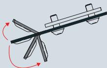
❶ Winkelstellung veränderbar durch Biegung nach innen: bis 90 Grad; nach außen: bis 45 Grad
