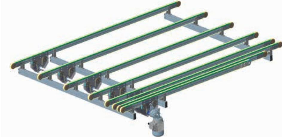
Die angetriebenen Zahnriemenförderer werden überwiegend zum innerbetrieblichen Transport von Stückgut oder Behältern verwendet. Das Fördererelement sind Zahnriemen mit Breiten von 16 – 50 mm, abgetragen auf einer Kunststoffgleitleiste oder einem Edelstahlgleitblech.
