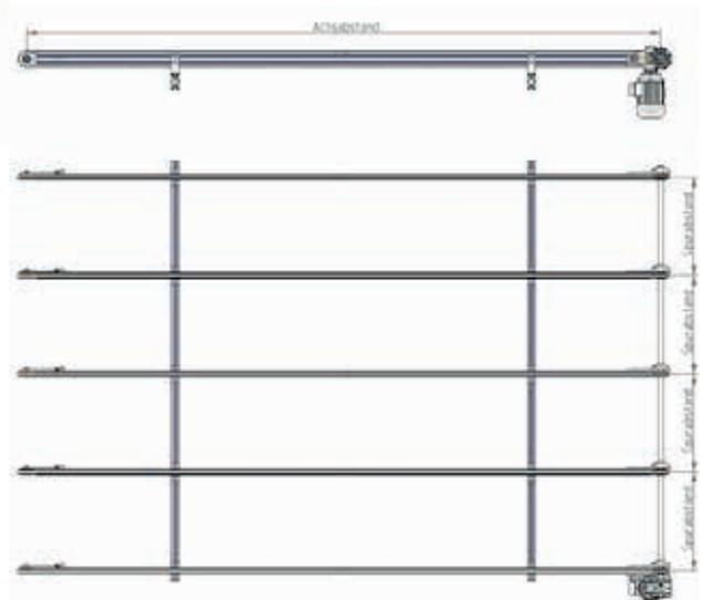
Die angetriebenen Zahnriemenförderer werden überwiegend zum innerbetrieblichen Längstransport von Platten oder Behältern verwendet. Das Förderelement sind Zahnriemen mit Teilung 5 oder 10 mm in den Breiten 16 – 32 mm, abgetragen auf einer Kunststoffgleitleiste.
