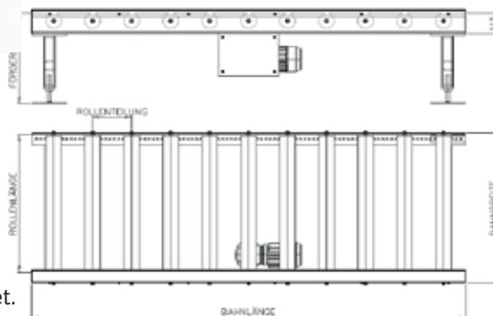
Die angetriebenen Palettenrollenbahnen sind geeignet für den horizontalen oder leicht steigenden Palettentransport.
