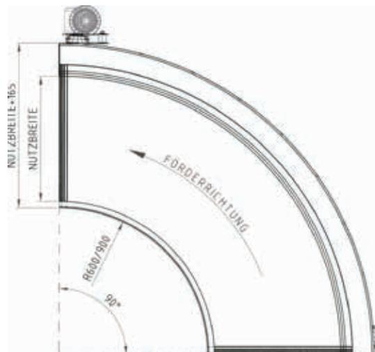
Die angetriebenen Förderbandkurven werden für den kontinuierlichen Warenfluss bei Eckumlenkungen benötigt. Durch die kleinen Umlenkrollen  $\varnothing 22, 47$  oder  $80$  mm am Bandanfang und Bandende können auch Kleinteile problemlos befördert werden.
