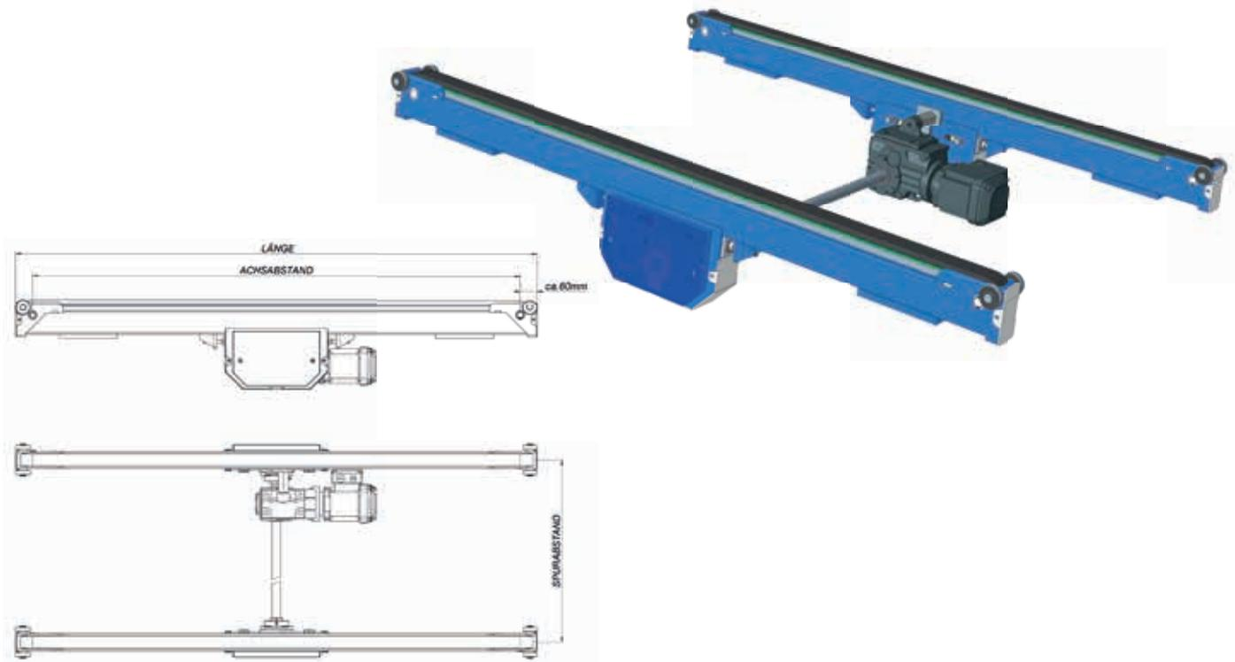
Die angetriebenen Kettenförderer werden vorwiegend zum innerbetrieblichen Quer- und Längstransport von Paletten verwendet. Das Tragelement ist eine Duplex-Rollenkette 10B-2 (5/8" x 3/8"), abgetragen auf Kunststoff- oder Stahlgleitleisten. Standardausführung mit 2, 3 oder 4 Spuren (angepasst an die Palette).
