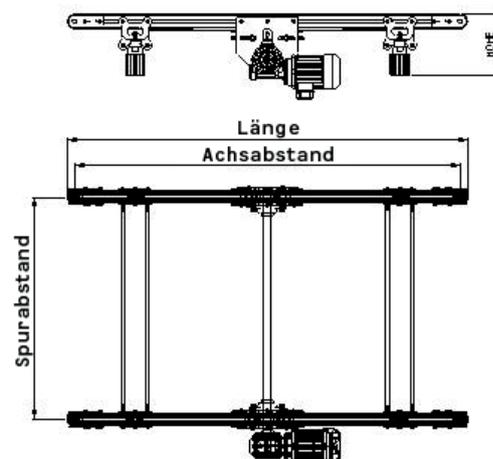
Die angetriebenen Zahnriemenförderer werden überwiegend zum Ein-/Ausschleusen von Behältern, Kartons oder Werkstückträger in eine Rollenbahn bzw. Förderstrecke verwendet.
