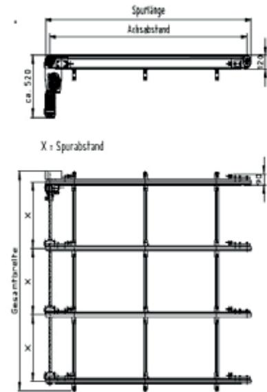
Die angetriebenen Zahnriemenförderer werden überwiegend zum innerbetrieblichen Längstransport von Platten oder Behältern verwendet.
