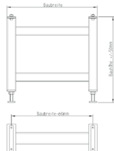
Die Verstellunterstützung UST 80 ist eine Schweißkonstruktion bestehend aus Formrohren 80x60x3 mm.
