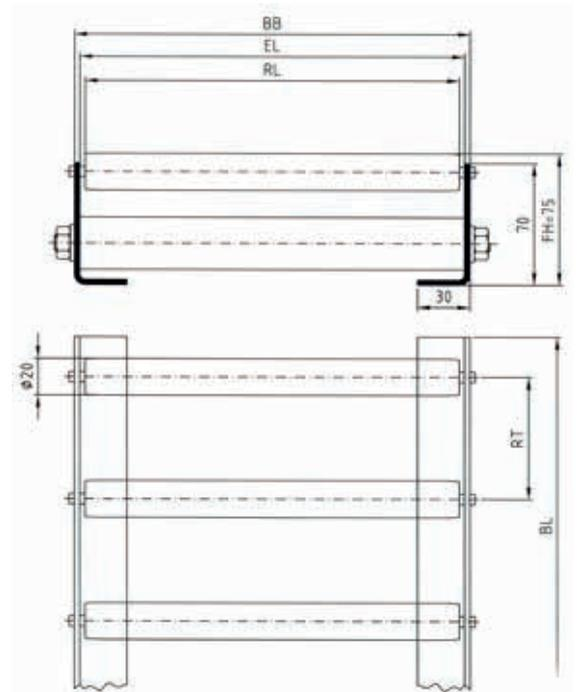
Die Schwerkraft-Minirollenbahnen sind geeignet für Stückguttransport. Horizontal durch händisches Weiterschieben oder durch Schwerkraft mit ca. 2 - 5 % Gefälle. Fördergut, Gewicht und Größe bestimmen die Rollenlänge und Rollenteilung.
