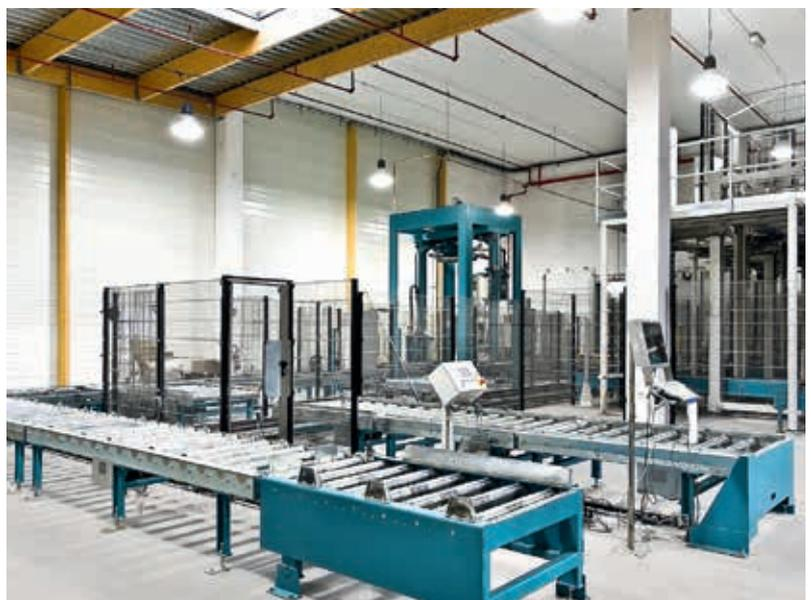
Rahmenlose Bauweise von Schutzzaunsystem FLEX II – optimale Prozesseinsicht ist bei hoher Sicherheit gewährleistet
