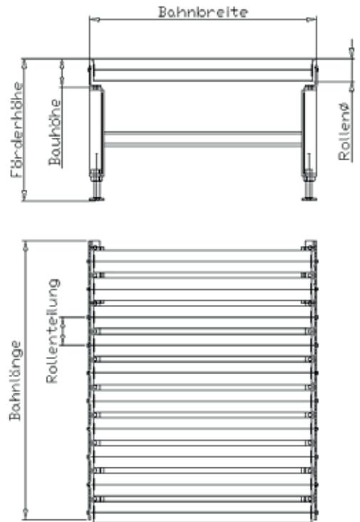
Die Schwerkraft-Palettenrollenbahnen sind geeignet für den horizontalen Palettentransport durch händisches Weiterschieben oder durch Schwerkraft mit ca. 2 - 5 % Gefälle in Kombination mit Bremstragrollen bzw. Bremsrollen [Siehe Seite 74 bzw. 75.]
