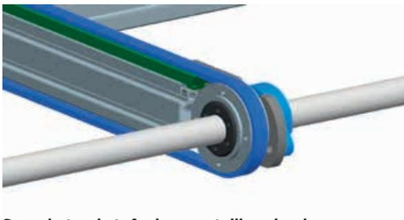
Spurabstand stufenlos verstellbar durch Wellenspannsatz im Antriebs-Zahnriemenrad
