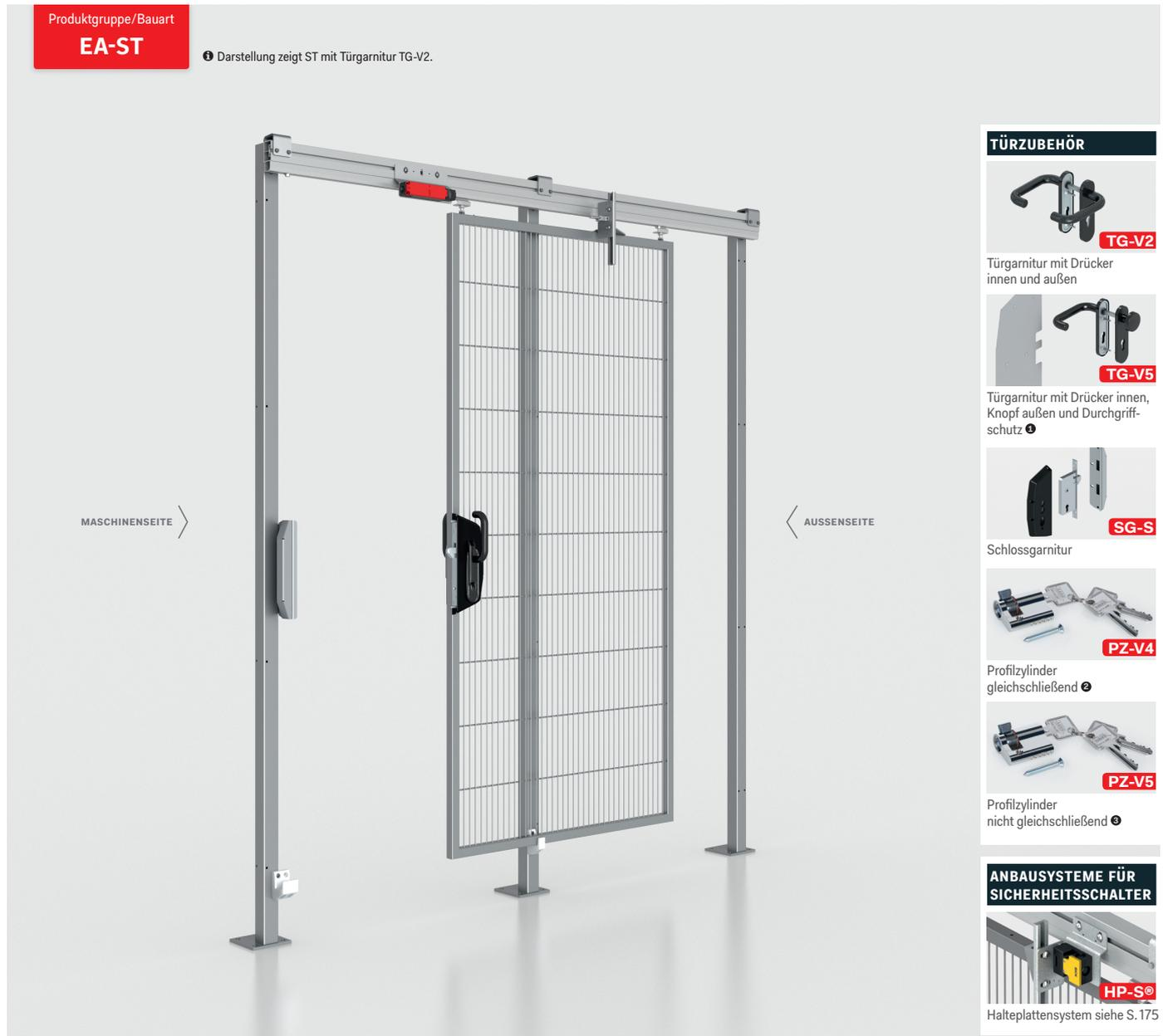
Das Spezialaluminiumprofil, langlebige Rollen aus Stahl und eine Führung aus Polyamid garantieren ein sehr leichtgängiges und genaues Öffnen und Schließen des Türflügels. Die Pfosten der Schiebetür bestehen aus einem stabilen Stahlprofil mit angeschweißter Vierlochbodenplatte. Standardmäßig sind beide Türpfosten für eine Eck- und Durchgangssituation vorbereitet.
