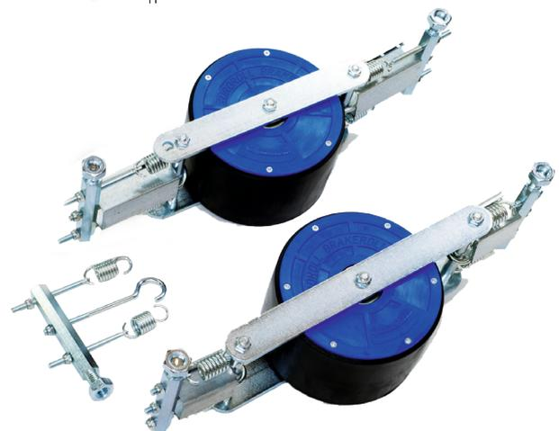
Die richtige Aufhängung der Bremsrolle ist wichtig, da nur über die erforderliche Anpressung ein schlupffreier Kontakt entsteht und so eine konstante Transportgeschwindigkeit erreicht wird.
