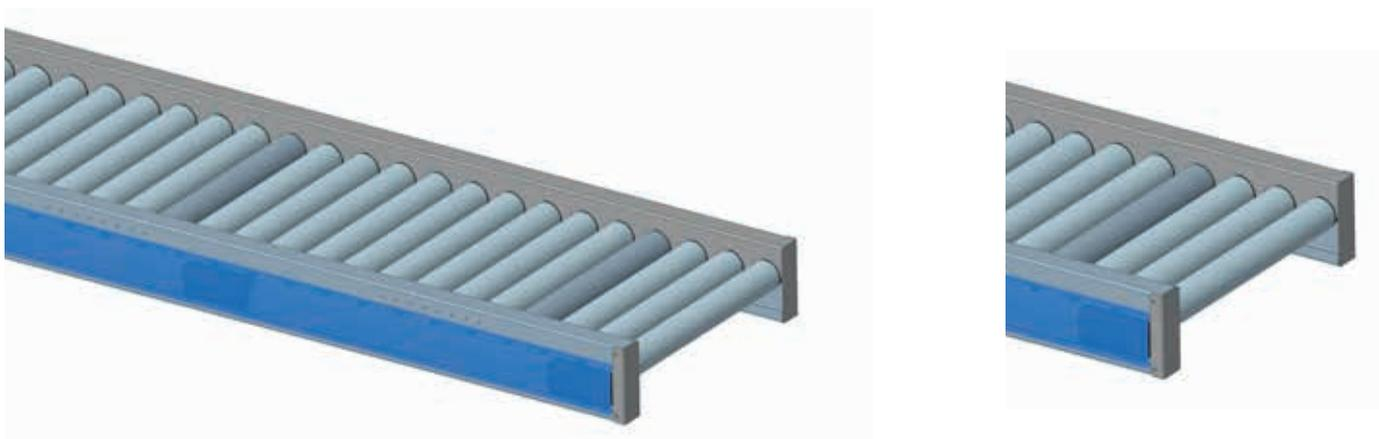
Der im Rohr integrierte Motor ermöglicht eine sehr kompakte Bauweise der Förderanlage. Kurze Förderstrecken mit Stückgutgewicht bis max. 35 kg, vor allem staudrucklose Rollenförderer. Es können Poly-V Riemen oder Zahnriemen zur Kraftübertragung genutzt werden. Es gibt einfache Steuergeräte, die externe Signale einer übergeordneten SPS benötigen, weiters gibt es Zonen-Steuerungen, mit welcher autarke, staudrucklose Förderer aufgebaut werden können.
