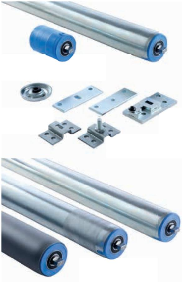
Bremsrollen und Bremstragrollen regeln die Geschwindigkeit des Fördergutes auf Schwerkraftrollenbahnen indem sie das Fördergut bei konstanter Ablaufgeschwindigkeit halten.
