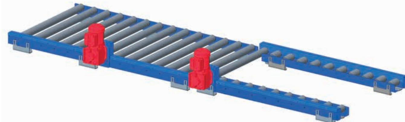
Die angetriebenen Rollenbahnen sind geeignet für den horizontalen Transport von Paletten. Die niedrige Förderhöhe von 85 mm und die in U-Form ausgeführte Rollenbahn, ermöglichen die Aufgabe/Entnahme einer Palette mit einem handelsüblichen Gabelhubwagen. Fördergut, Gewicht und Größe bestimmen die Rollenlänge und Rollenteilung. In Laufrichtung muss das Fördergut mindestens auf 3 Rollen aufliegen.
