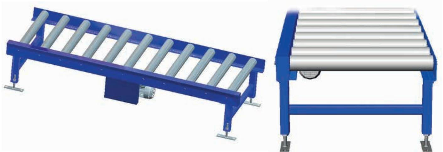
Die angetriebenen Palettenrollenbahnen sind geeignet für den horizontalen oder leicht steigenden Palettentransport. Fördergut, Gewicht und Größe bestimmen die Rollenlänge und Rollenteilung. In Laufrichtung muss das Fördergut mindestens auf 3 Rollen aufliegen.
