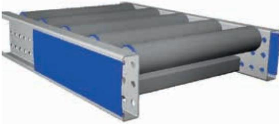
Die Schwerkraft-Leichtrollenbahnen sind geeignet für Stückguttransport. Horizontal durch händisches Weiterschieben oder durch Schwerkraft mit ca. 2 - 5 % Gefälle in Kombination mit Bremstragrollen bzw. Bremsrollen. [Siehe Seite 74 bzw. 75.] Fördergut, Gewicht und Größe bestimmen die Rollenlänge und Rollenteilung. In Laufrichtung muss das Fördergut mindestens auf 3 Rollen aufliegen.
